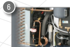
6 Secador de ar comprimido por refrigeração
